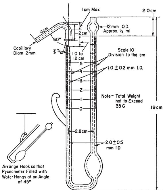
FIG. 1 Pycnometer
